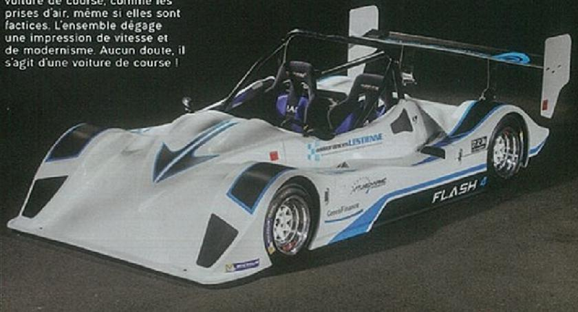
Le concept de barquette permet d'avoir un passager à côté du pilote. L'arceau de sécurité répond aux normes FIA.
