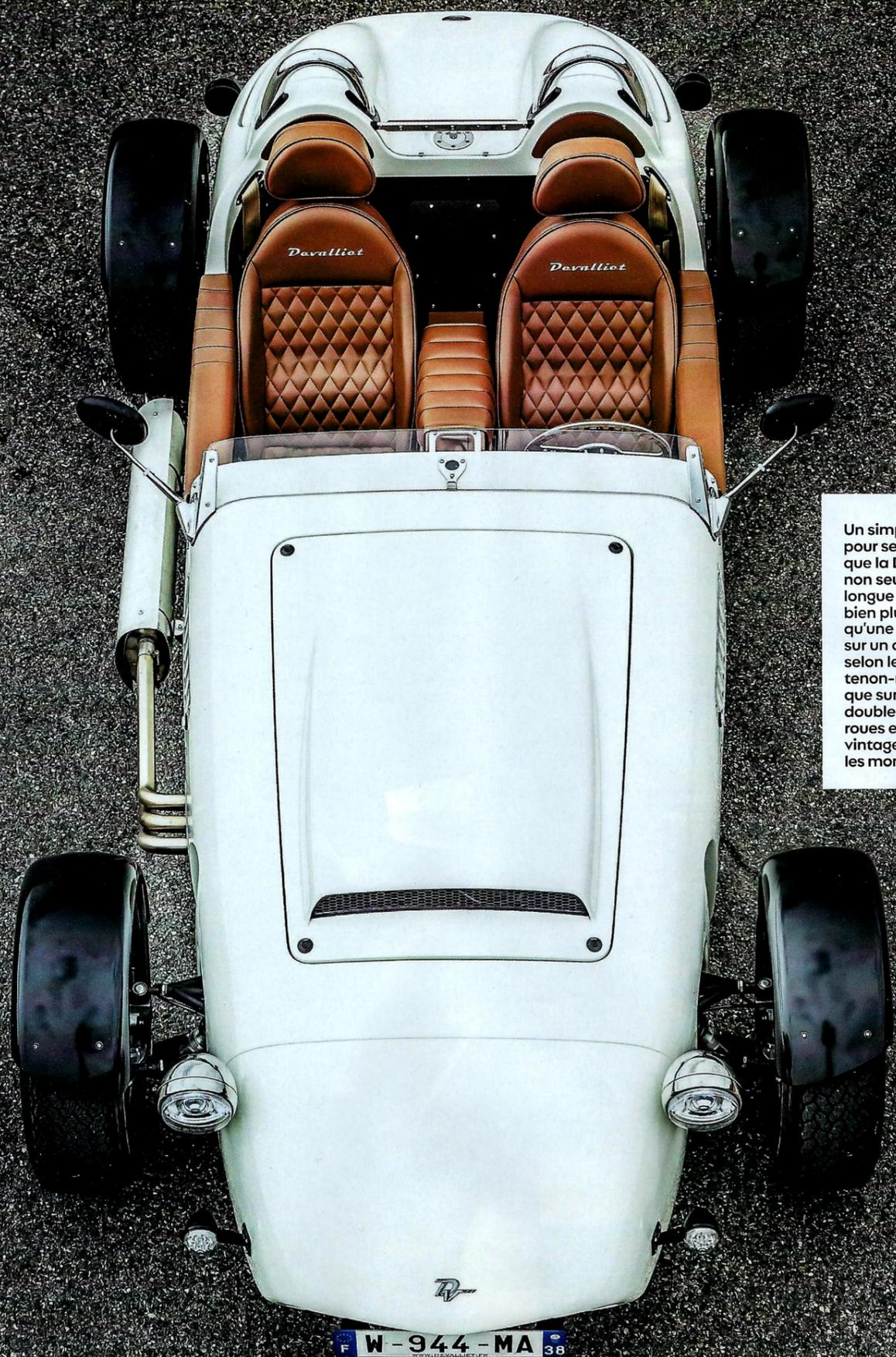
Un simple coup d'œil suffit pour se rendre compte que la Devalliet Mugello est non seulement plus longue (3,86 m) mais aussi bien plus large (1,76 m) qu'une Caterham. Elle repose sur un châssis en aluminium selon le principe d'assemblage tenon-mortaise ainsi que sur des suspensions à double triangulation. Ses roues extérieures et son style vintage rappellent les monoplaces des années 50.
