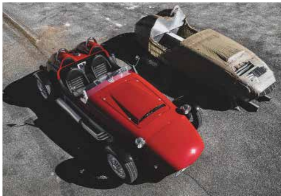
La première fois que l'équipe a pu se rendre compte de la taille et du rendu de la voiture, c'est grâce à une maquette à échelle 1 réalisée à partir de dizaines de plaques en métal recouvertes de scotch.
