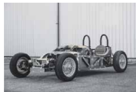
Le châssis est monté en trois parties distinctes afin de faciliter les personnalisations de la voiture en termes de berceau avant et arrière.
